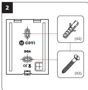
**2** Positionnez les 2 chevilles plastiques dans les trous. Puis Fixez le fond du DGA sur le support de votre choix, à l'aide des vis cruciformes à têtes fraisées. Passez le câble électrique du DGA dans son ouverture et fixez le à son support par le haut avec le crochet supérieur.
