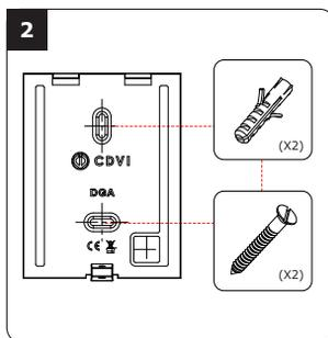
Breng de 2 plastic pluggen in. Monteer daarna de bevestigingsplaat van het DGA codeklavier, en schroef deze op de muur met de (M4x30) bevestigingsschroeven. Stop de kabel van het codeklavier in het bedradingsgebied. Plaats het codeklavier op de bevestigingsplaat, bovenkant eerst en verzeker u ervan dat het past over de volledige lengte en breedte fits van de bevestigingsplaat.
