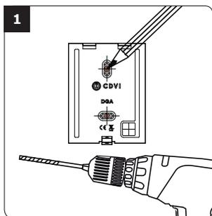
Teken de boorgaten af met de montageplaat van de DGA. Boor de 2 bevestigingsgaten (Ø 5 MM deeltje en 35 MM diepte minimum) en vergeet de boorgaten voor de bekabeling niet.
