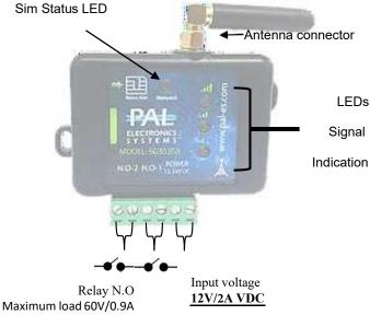
Deze afbeelding is van de PA300600, de PA400700 heeft een draadloze ontvanger op afstand, aangezien de afstandsbediening via de App wordt beheerd zijn de functionaliteiten hetzelfde.
